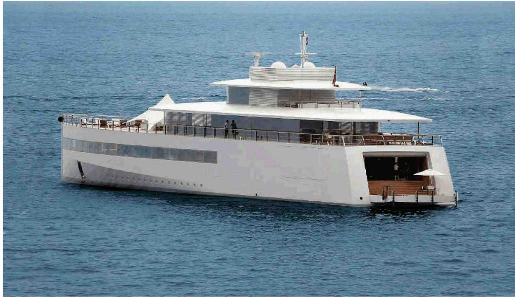
Venus, voluto da Steve Jobs, costruito da Feadship e varato nel 2012. È lungo 80 metri e ha un design superminimal: struttura in alluminio, pavimenti di vetro, ponti rivestiti di teak e una plancia di comando con ben sette iMac con display da 27 pollici. Pensato per lunghe crociere, è un castello galleggiante con ampie vetrate dotate di veneziane. Nessuno ha mai visto gli interni.
