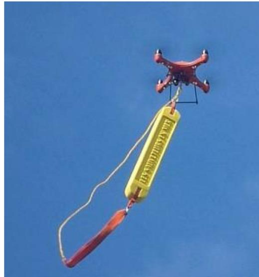
*Drone de sauvetage expérimenté à la station des Saintes.*
